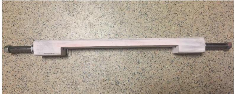
(caoutchouc). Une fois fixée, vous pourrez glisser vos roues et les bloquer avec un écrou.
