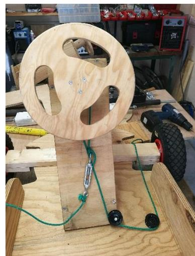
Construire la caisse pour le volant, le volant et trouver un axe. Les deux cordelettes de direction seront reliées au volant par un système de poulies. Une double vis permettra de garder la
